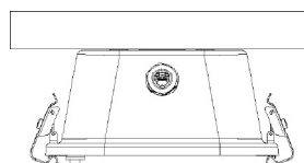
Obr. 3 Přímé uchycení na strop či stěnu
